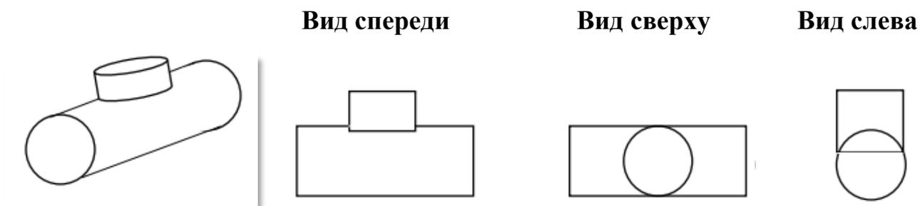
Рисунок 1 Проекция детали
